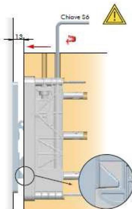
Innesto automatico antiribaltamento dopo 3 mm di corsa
