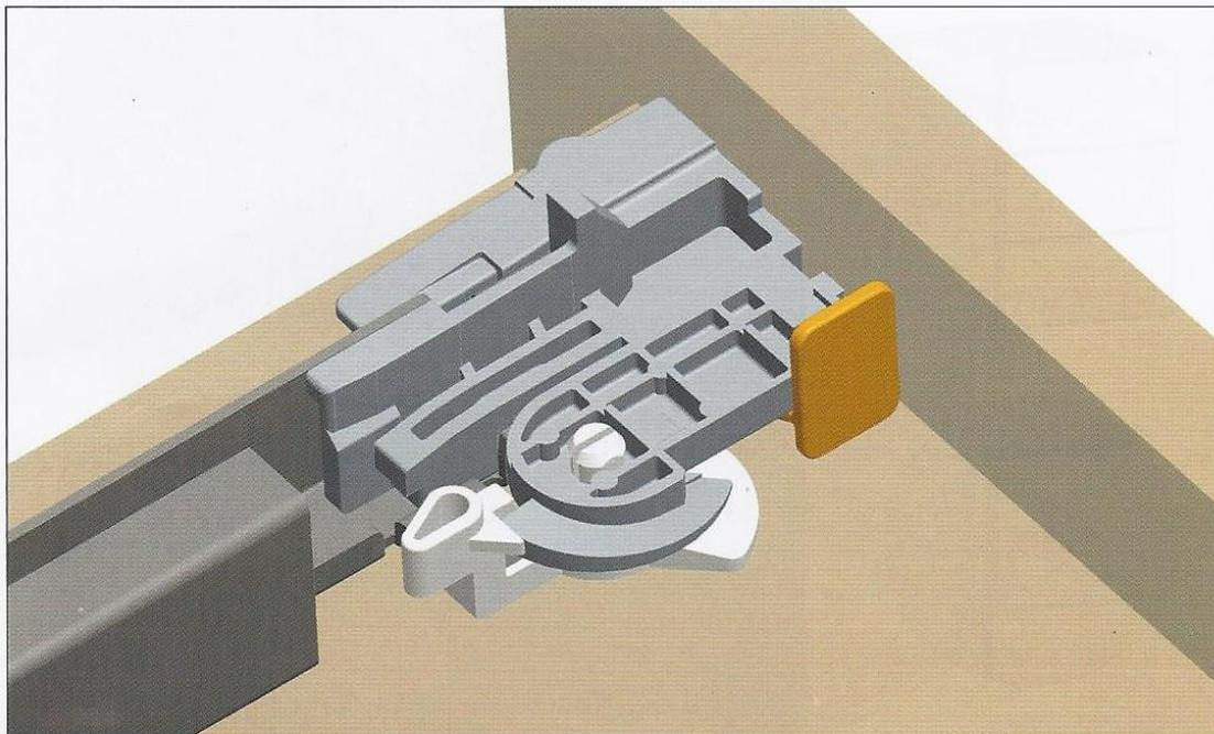
Ruotare la leva verso il frontale del cassetto per ottenere la regolazione verticale.
